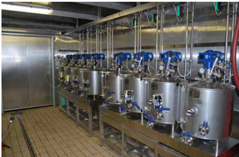
LA BATTERIA DI MINI AUTOCLAVI PER LA MICROSPUMANTIZZAZIONE SPERIMENTALE
